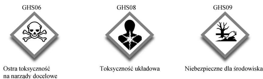
Rys. 1. Piktogramy określone w rozporządzeniu WE nr 1272/2008 (CLP) mają czarny symbol na białym tle z czerwonym obramowaniem, na tyle szerokim, aby było wyraźnie widoczne
