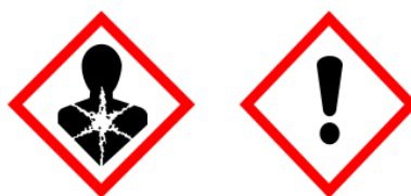
Rys. 1. 2-Nitroanizol. Kody hasła ostrzegawczego: Niebezpieczeństwo. Piktogramy określone w załączniku do rozporządzenia WE nr 1272/2008 (CLP) mają czarny symbol na białym tle z czerwonym obramowaniem na tyle szerokim, aby było wyraźnie widoczne
