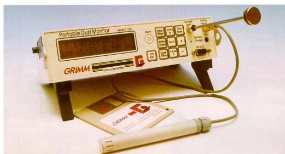
Rys. 10. Licznik optyczny GRIMM Dust Monitor model 1.108
