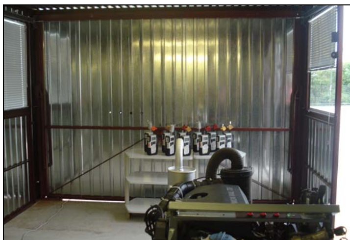
Rys. 8. Silnik Diesla do generowania spalin wraz z aparaturą do pobierania próbek frakcji stałej spalin
