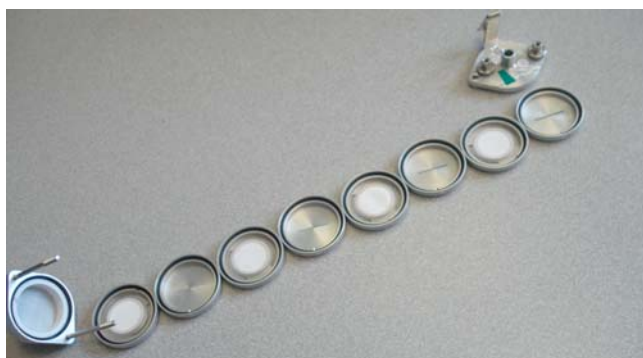
Rys. 6. Próbnik typu PCIS wraz z filtrami przed pobraniem próbek frakcji cząstek stałych zawartych w spalinach silników Diesla
