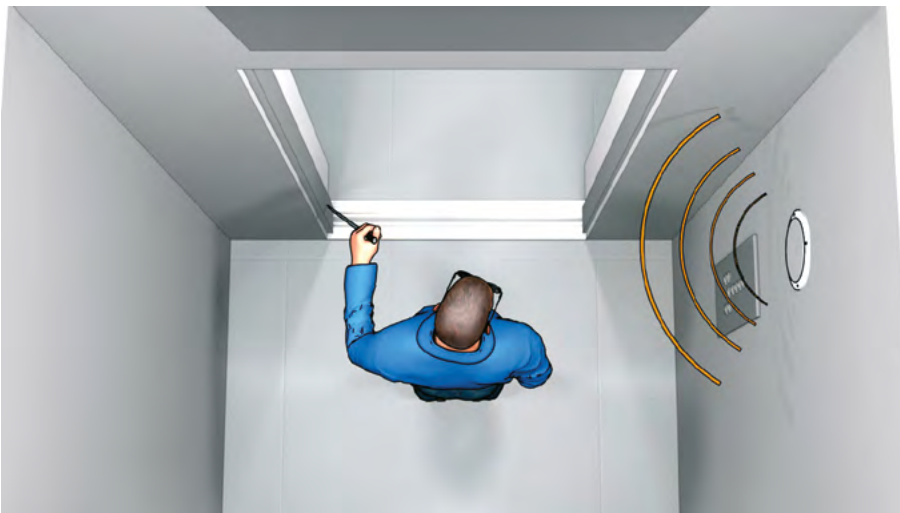
Rys. 4-8. Przykład dostosowania dźwigu osobowego do potrzeb osób z niepełnosprawnością wzroku (źródło: CIOP-PIB)
