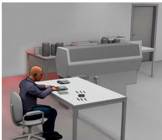
Rys. 4-12. Przykład zastosowania indywidualnego systemu bezpieczeństwa z funkcją wibracji (źródło: CIOP-PIB)
