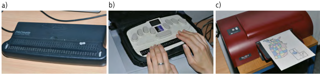
Rys. 4–10. Przykładowe narzędzia przeznaczone dla osób z niepełnosprawnością wzroku: a) monitor brajlowski, b) notatnik brajlowski, c) drukarka brajlowska (źródło: CIOP-PIB)
