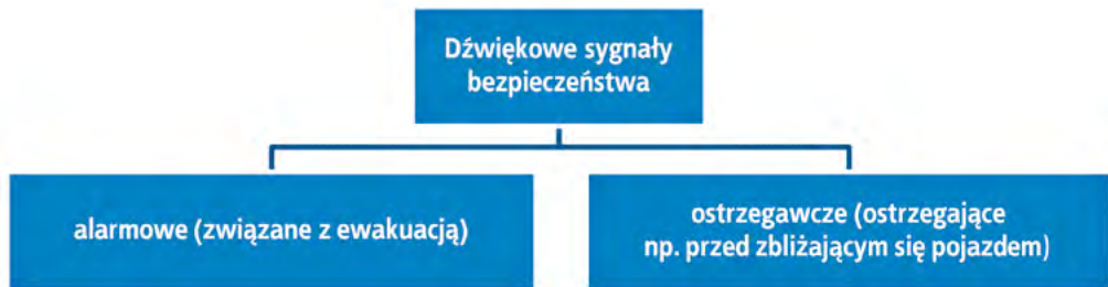
Rys. 4-5. Podział dźwiękowych sygnałów bezpieczeństwa (źródło: CIOP-PIB)
