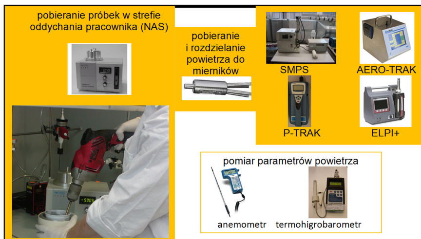
Rys. 3. Ogólny schemat stanowiska pomiarowego do badania emisji cząstek w celu oceny narażenia na nanoobjekty
