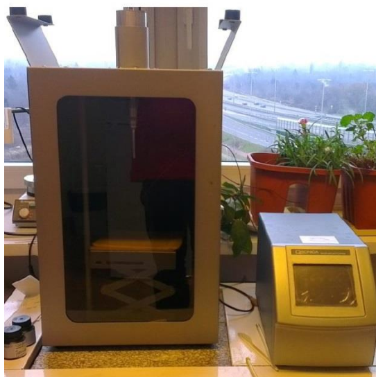
Rys. 3. Dezintegrator ultradźwiękowy Q 700 firmy Qsonica stanowiący wyposażenie Pracowni Bezpieczeństwa Chemicznego CIOP-PIB (fot. własna)
