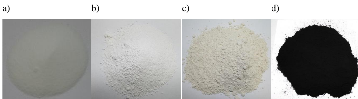
Rys. 2. Przykładowe nanonapełniacze stosowane do modyfikacji kompozytów polimerowych w postaci a) poliedrycznego oligomerycznego silseskwioksanu, b) ditlenku tytanu, c) glinokrzemianu warstwowego, d) wielościennych nanorurek węglowych (fot. własne)
