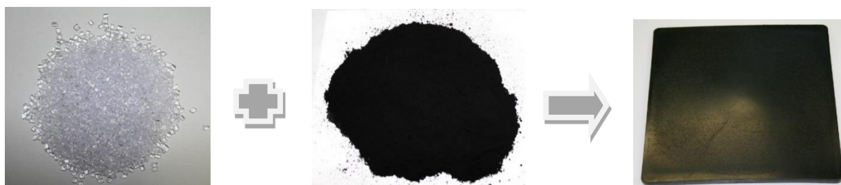
Rys. 1. Wygląd próbki nanokompozytu polimerowego osnowę, którego stanowi polimer termoplastyczny, zaś napełniaczem są nanorurki węglowe (fot. własne)
