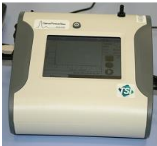
Rys. 6. Miernik optyczny OPS (TSI Inc., rozkład wymiarowy cząstek od 300nm – 10 \mu m) (fot. własna)
