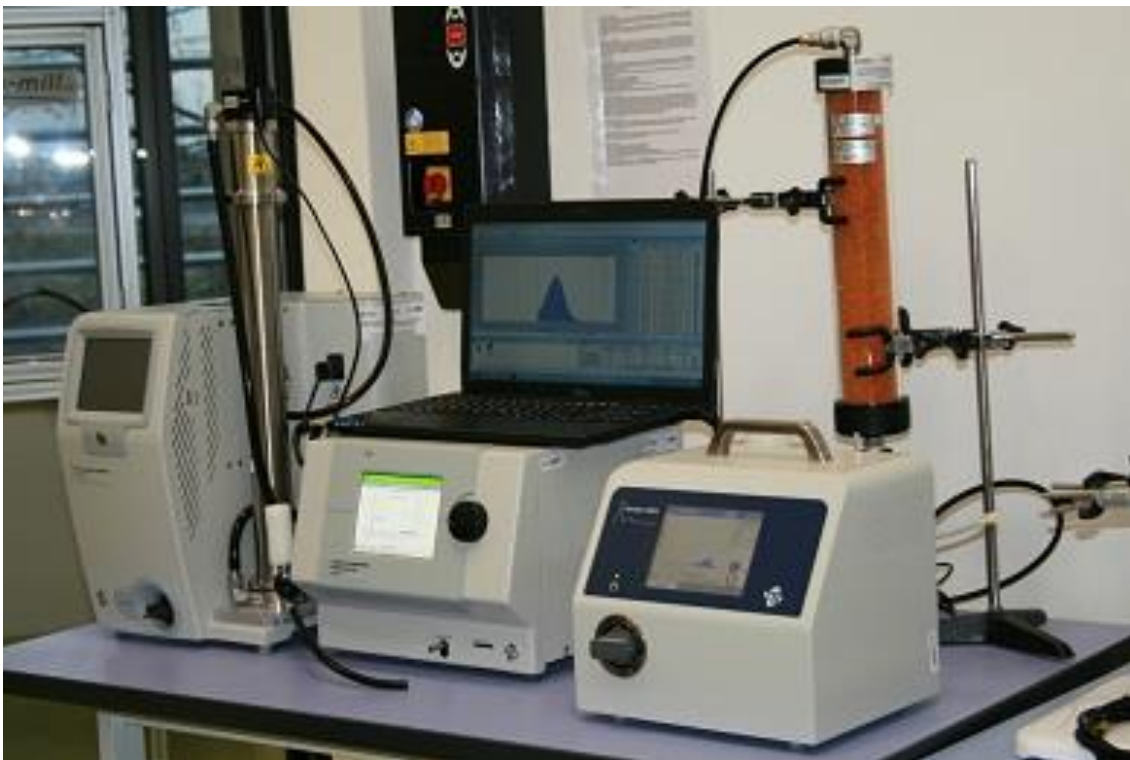
Rys. 5. System analizy wymiarowej cząstek SMPS (TSI Inc.) – dwa urządzenia od lewej (rozkład wymiarowy cząstek w zakresie 10 – 1000 nm) oraz miernika Nano SMPS (po prawej, rozkład wymiarowy cząstek w zakresie 10 – 420 nm) (fot. własna)
