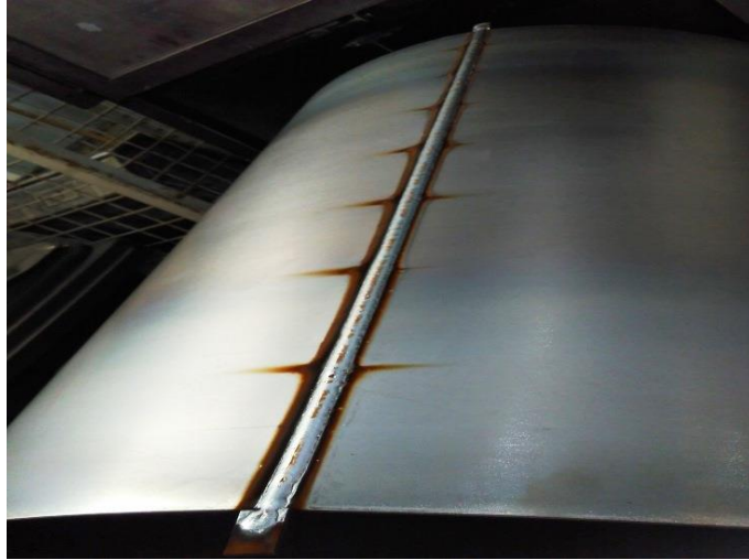
Spoina spawalnicza powstająca po spawaniu blachy w formę walca, która poddawana jest szlifowaniu.
