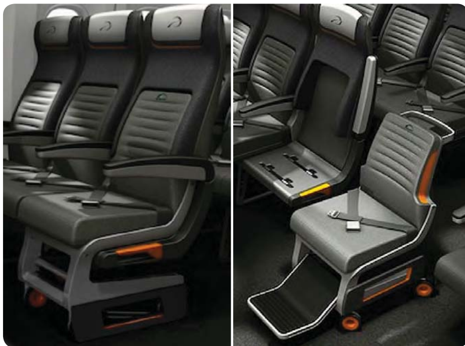
Rys. Konceptcja krzeselka transportowego zintegrowanego z układem foteli samolotu (źródło: [12]) Fig. Concept of a transport chair integrated with an airplane seat (source: [12])
