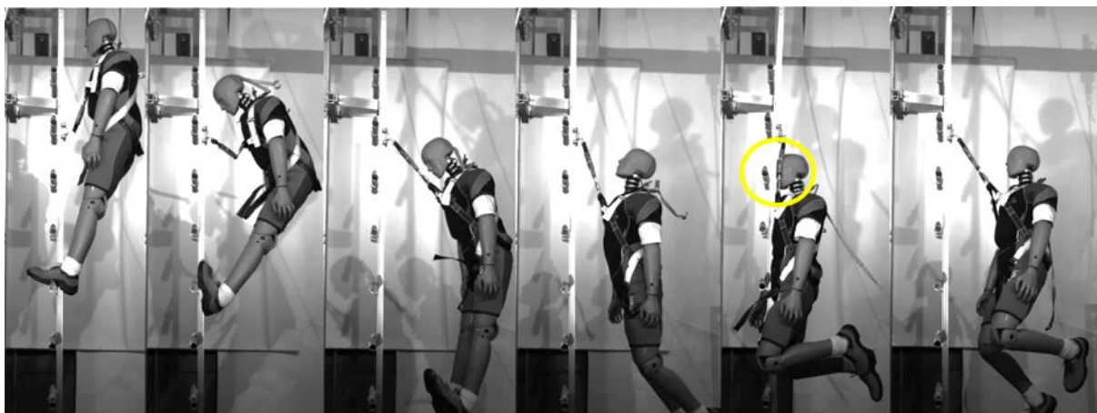
Rys. 7. Uderzenie głową o prowadnicę urządzenia samozaciskowego podczas powstrzymywania spadania
