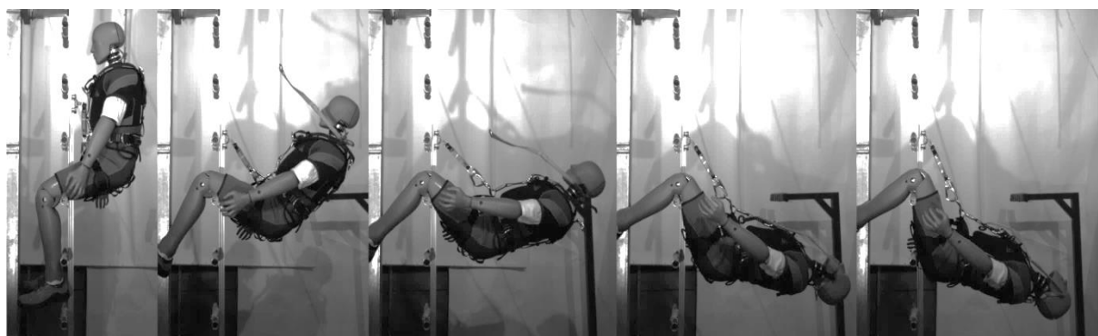
Rys. 8. Przyjmowanie niebezpiecznej pozycji przez człowieka podczas i po powstrzymaniu spadania przez urządzenie samozaciskowe ze sztywną prowadnicą w postaci szyny
