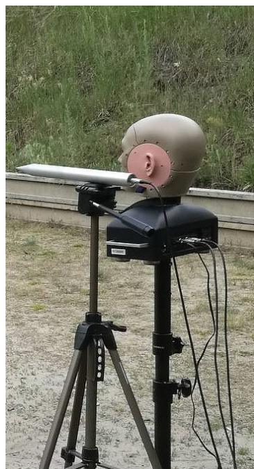
Rys. 3. Układ pomiarowy przeznaczony do pomiaru właściwości akustycznych ochronników słuchu: na pierwszym planie – przetwornik pomiarowy umożliwiający wyznaczenie niezbędnych poprawek, po prawej stronie – tester akustyczny wyposażony m.in. w symulatory uszu, układ podgrzewania oraz elementy wykonane z materiału symulującego właściwości skóry
