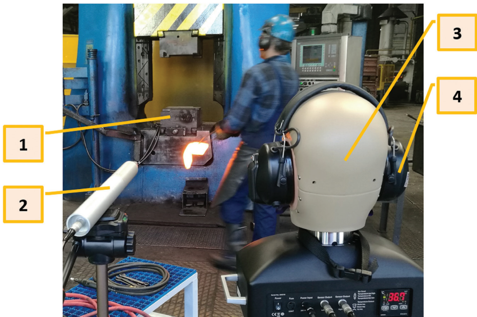
Rys. 5. Układ pomiarowy wykorzystywany w trakcie badań ograniczania przez ochronniki słuchu z regulowanym tłumieniem hałasu impulsowego, wytwarzanego podczas obróbki metalu: 1 – młot parowo-matrycowy (źródło hałasu), 2 – przetwornik do pomiaru właściwości impulsów akustycznych, 3 – tester akustyczny do pomiaru właściwości akustycznych ochronników słuchu, 4 – nauszniki przeciwhałasowe z regulowanym tłumieniem
