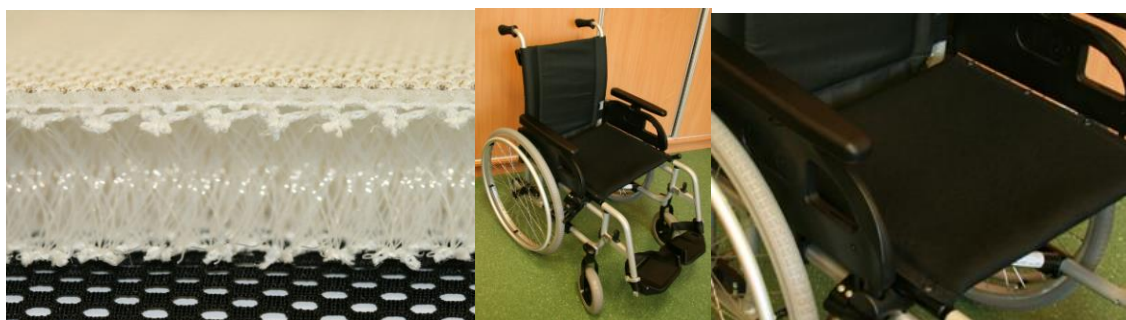
Projekt III.N.17. Model wielofunkcyjnego układu włókienniczego i wózek inwalidzki z opracowanym siedziskiem
