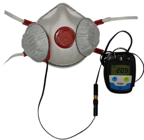
Projekt III.N.12. Półmaska filtrująca wyposażona we wskaźnik tlenu: (a) – widok z przodu, (b) – widok wewnętrznej strony półmaski
