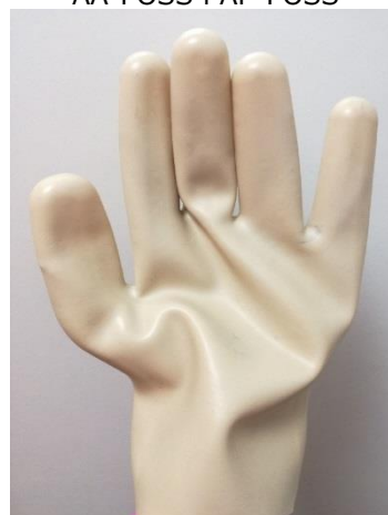
Rękawica z kauczuku butadienowo-akrylonitrylowego z zaimplementowanymi silseskwioksanami: AA-POSS i AP-POSS
