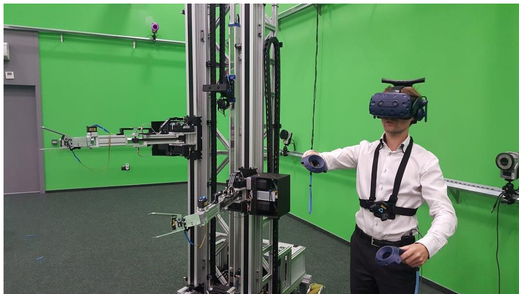
Projekt III.N.04. Zbudowany model laboratoryjny dwuramiennego robota mobilnego zdalnie sterowany przez operatora z wykorzystaniem narzędzi typowych dla technik rzeczywistości wirtualnej
