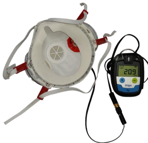
Projekt III.N.12. Półmaska filtrująca wyposażona we wskaźnik tlenu: (a) – widok z przodu, (b) – widok wewnętrznej strony półmaski
