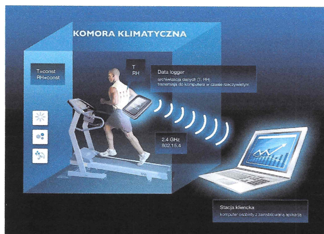
Rys. 2 Schemat działania systemu do pomiaru temperatury i wilgotności w przestrzeni międzyodzieżowej z rejestracją i bezprzewodową transmisją danych – zastosowanie w warunkach laboratoryjnych.
