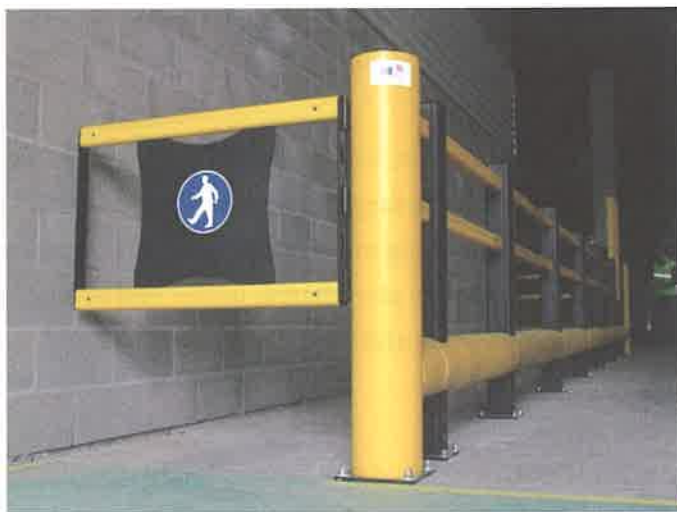
Rys. 2-13. Oddzielenie drogi dla pieszych od stref ruchu i pracy wózków za pomocą ochronnych barier fizycznych z tworzywa sztucznego (ilustracje dzięki uprzejmości firmy Evergrip sp. z o.o., Warszawa)
