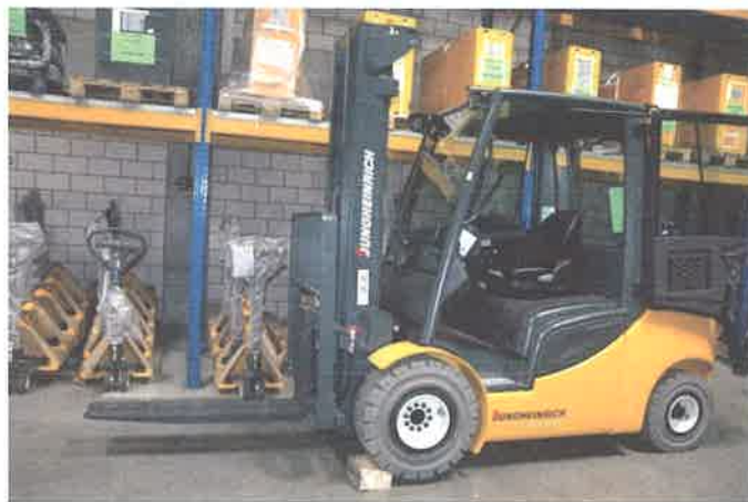
Rys. 4-7. Wózek z hamulcem pomocniczym działającym samoczynnie (przednie koła uniesione na klockach – wózek jest zahamowany)
