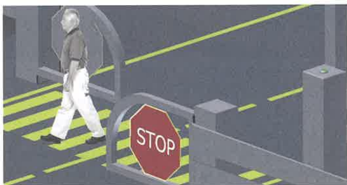
Rys. 2-16. Rozwiązanie przejścia dla pieszych z zachowaniem bezpieczeństwa
