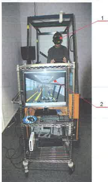
Rys. 2-42. Symulator wózka podnośnikowego stosowany w badaniach w CIOP-PIB
