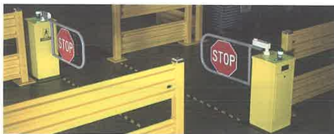
Rys. 2-17. Ręcznie sterowane przejście dla pieszych
