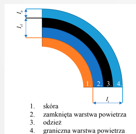
Rys. 1. Przedstawienie graficzne podstawowej izolacyjności cieplnej ( I_b ), granicznej warstwy powietrza ( I_a ) oraz całkowitej izolacyjności cieplnej ( I_t ) [1] – schemat uproszczony (jedna warstwa odzieży)
