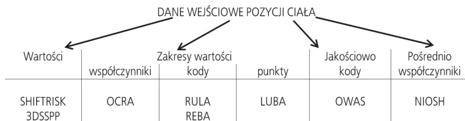
Rys. VII-1. Sposób definiowania danych wejściowych dotyczących położenia członów ciała w różnych metodach oceny obciążenia zewnętrznego
