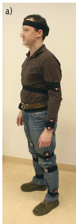
Rys. IV-15. Miejsca umieszczenia czujników podczas rejestracji ruchu w programie FAB Recorder: a) czujniki umieszczone na ciele osoby badanej, b) zaznaczenie obszarów ciała podlegających badaniu w programie komputerowym sterującym pomiarem
