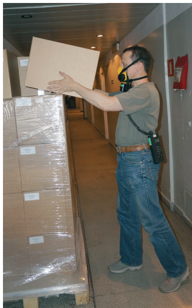
Rys. V-3. Pomiar wydychanego powietrza z zastosowaniem maski MWE
