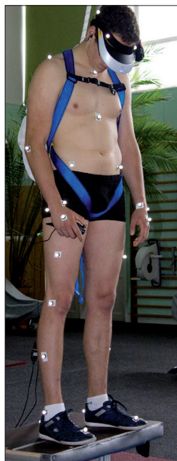
Rys. IV-14. Rejestracja położenia członów ciała z zastosowaniem świecących diod (Milanowicz i Budziszewski, 2013)
