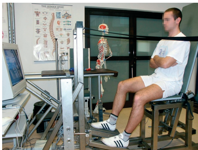
Rys. IV-22. Pomiar maksymalnej siły nacisku na pedał
