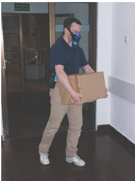
Fot.1. Pomiar wydatku energetycznego na stanowisku pracy metodą oceny wentylacji płuc
