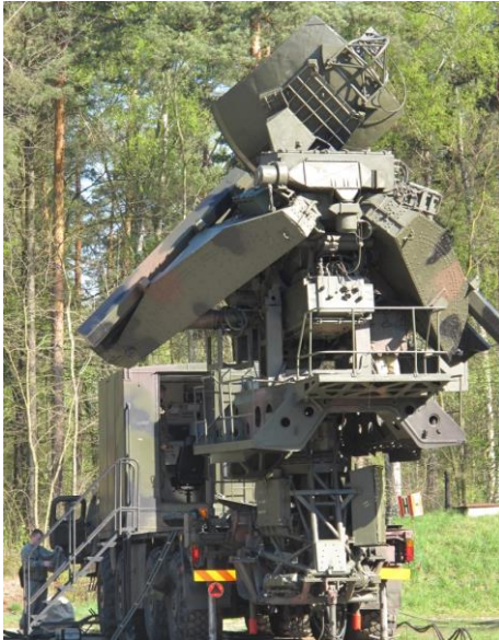
Rys. 11. Stacja naprowadzania rakiet – urządzenie wytwarzające niestacjonarne nieokresowe pole elektromagnetyczne [zbiory WIHE]
