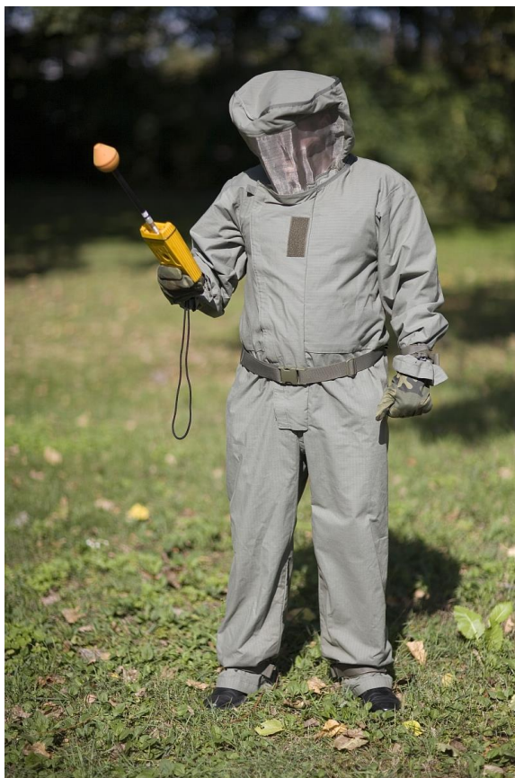
Rys. 4. Specjalny ubiór ochronny chroniący przed promieniowaniem-EM
