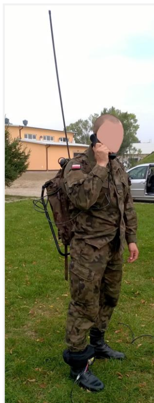
Rys. 17. Operator radiostacji plecakowej z miernikiem kłamrowym do pomiarów prądów indukowanych umieszczonym na nodze
