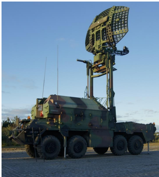
Rys. 10. Stacja radiolokacyjna – urządzenie wytwarzające niestacjonarne okresowe pole elektromagnetyczne [zbiory WIHE]
