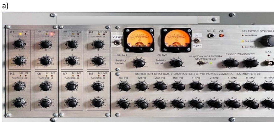
Rys. 4 Prototyp systemu maskującego: a) widok generatora-wzmacniacza, b) widok kolumny dźwiękowej (od góry).
