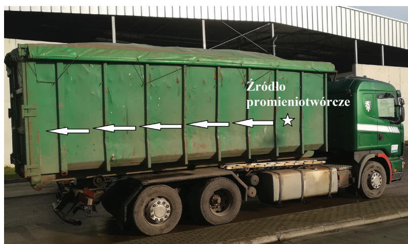
Rycina 3. Ciężarówka przewożąca odpady komunalne z zaznaczonym źródłem poszukiwanym podczas zdarzenia radiacyjnego. Strzałki oznaczają kierunek przemieszczania się źródła w momencie wyładunku (źródło: WSSE w Rzeszowie)
