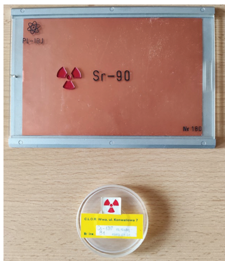
Rycina 4. Wyposażenie pomiarowe stosowane w badaniach promieniowania jonizującego: a) źródła promieniotwórcze do sprawdzania mierników; b) miernik typu InSpector 1000; c) miernik typu EKO-C (źródło: WSSE w Rzeszowie)
