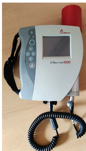
Rycina 4. Wyposażenie pomiarowe stosowane w badaniach promieniowania jonizującego: a) źródła promieniotwórcze do sprawdzania mierników; b) miernik typu InSpector 1000; c) miernik typu EKO-C (źródło: WSSE w Rzeszowie)
