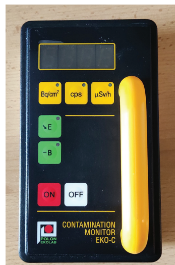
Rycina 4. Wyposażenie pomiarowe stosowane w badaniach promieniowania jonizującego: a) źródła promieniotwórcze do sprawdzania mierników; b) miernik typu InSpector 1000; c) miernik typu EKO-C (źródło: WSSE w Rzeszowie)
