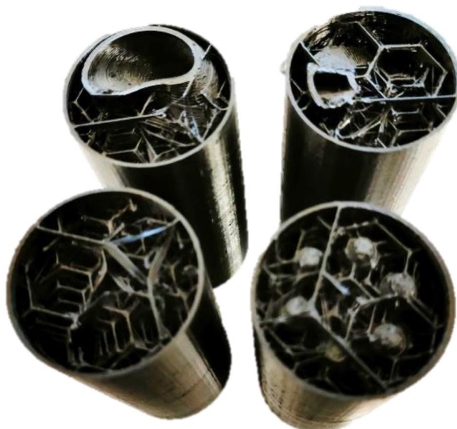
Rys. 1. Próbkki metamateriału akustycznego o zmiennej gęstości wypełnienia.
