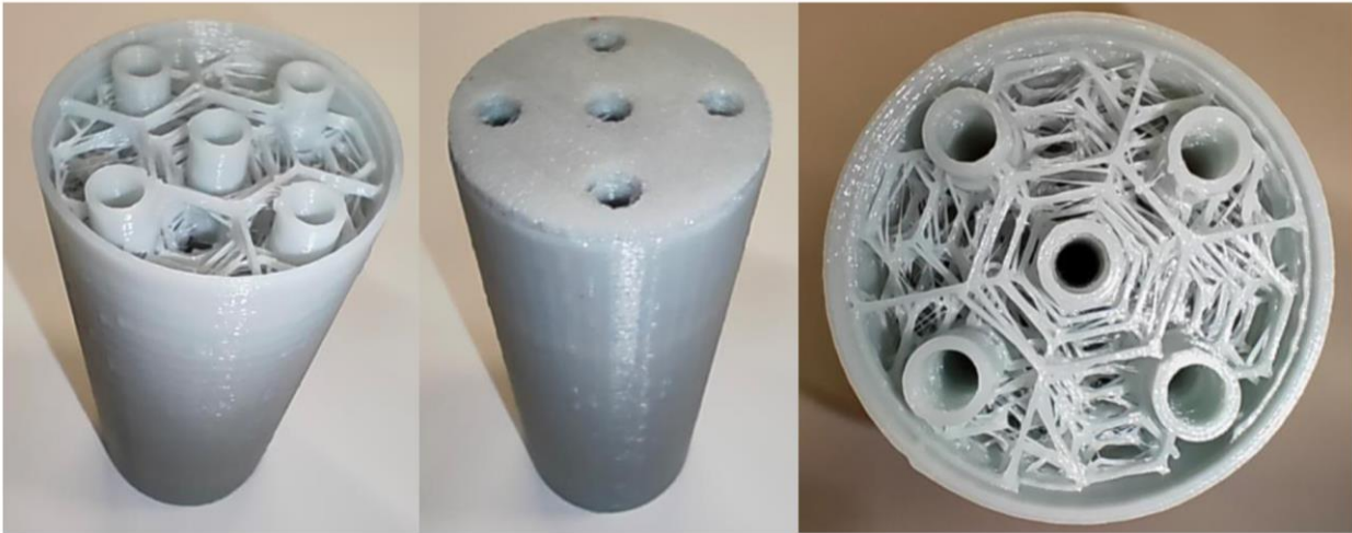
Rys. 3. Model metamateriału akustycznego poddany badaniom z wykorzystaniem rury impedancyjnej.
