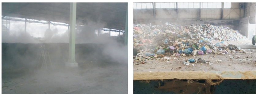
Ryc. 3. Zwiększona emisja pyłów organicznych podczas przerzucania pryzm kompostu (A) i dostarczania odpadów do sortowni (B), (fot. Katarzyna Konopczyńska)
