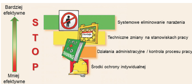
Ryc. 8. Ograniczanie ryzyka zawodowego wg filozofii STOP (źródło: archiwum CIOP-PIB)
