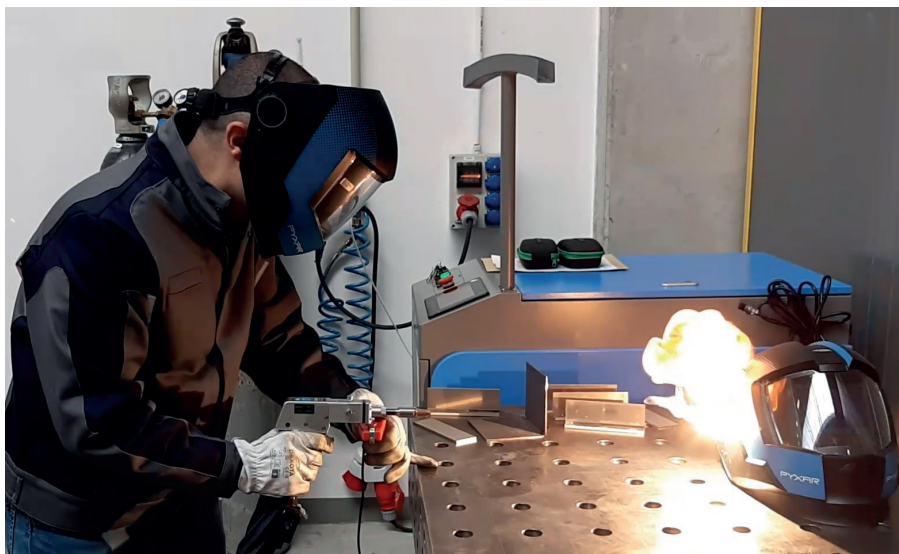
Fot. Płomień pojawiający się po skierowaniu wiązki laserowej z urządzenia do ręcznego spawania laserowego w stronę tradycyjnej przyłbicy spawalniczej (źródło: CIOP-PIB, za zgodą firmy RYWAL RHC)
